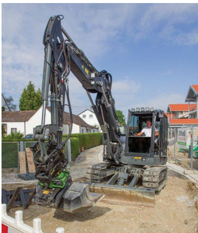
Rückenbelastende Arbeiten mit Schaufel und Schubkarre übernimmt der Tiltrotator.
